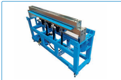
Système de poinçonnage automa- tique pour tirant
